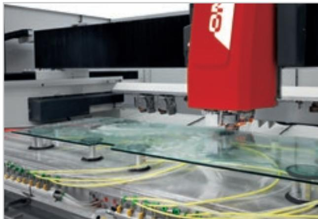
Usinagem completa de uma porta: fresagem e lapidação de entalhe, lapidação e polimento periférico.
