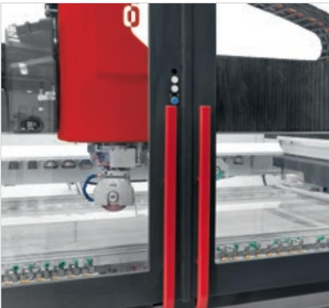
Fechadura elétrica de segurança com botoneira ergonômica integrada para abertura das portas e Início da usinagem, para a máxima rapidez e conforto do operador.
